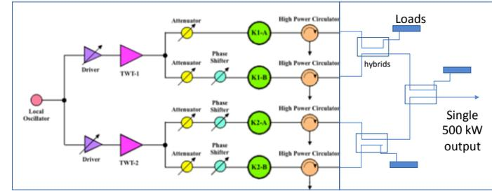
8 GHz klystrons, 500 kW
