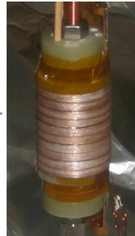
Solenoido con nastri 2G YBCO coated conductors
