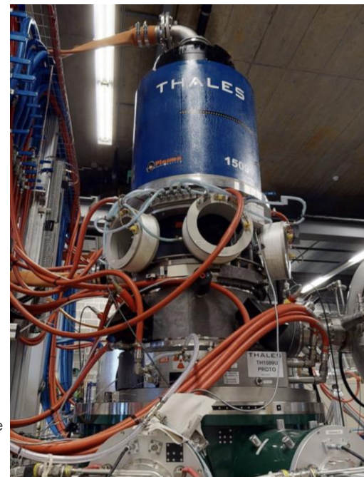
Girotrone da 170 GHz 1 MW sviluppato per ITER e DTT in sperimentazione a SPC-EPFL.
